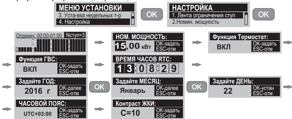
Рисунок 31. Настройка внутренних параметров и установок.
