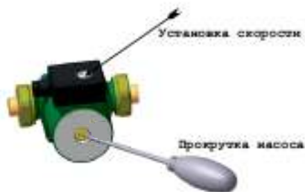
Рисунок 36. Схема обслуживания насоса.
